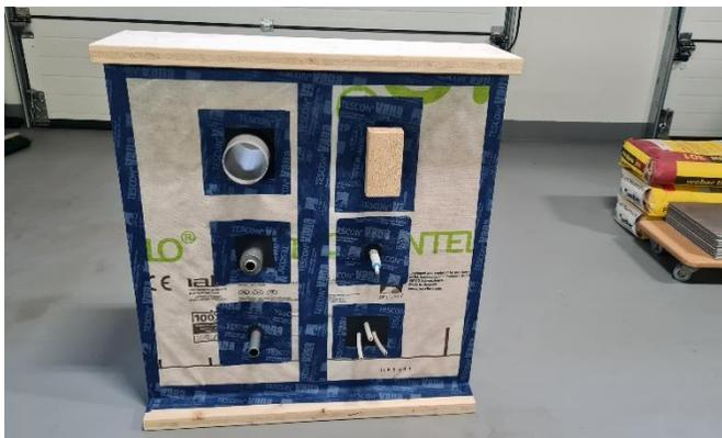
Bild: Fertig abgedichteter Prüfkörper
